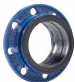
Серия 05 Комбифланец для чугунных труб, упругий. Ковкий чугун DN 50-300 PN10 или PN16.
