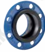
Серия 05 Комбифланец для ПЭ и ПВХ труб, упругий. Ковкий чугун DN 50-300 PN10 или PN16
