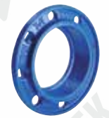
Серия 05 Комбифланец для труб из НПХВ, стали или ковкого чугуна, неупругий. Ковкий чугун DN 400-600 (трубы НПХВ и ковк.чуг.) DN 50-300 (трубы из стали) PN10 или PN16
