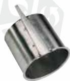
Серия 05 Опорная втулка для ПЭ труб Подходит к Supra Maxii™, Supra Plus™ и комбифланцев Нержавеющая сталь. DN 50-400 PN 6,3 PN10 или PN16
