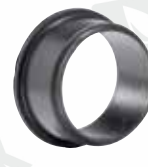
Серия 05 Уплотнение комбифланца для труб из НПХВ, стали или ковкого чугуна, неупругое. Резина SBR DN 400-600 (трубы НПХВ и ковк.чуг.) DN 50-300 (трубы из стали)
