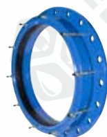
Серия 260 Муфта сборная и фланцевый адаптер для труб из АЦ, стали, серого и ковкого чугуна. Сталь. DN 350-2000 PN10, PN16 или PN 25
