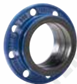
Серия 05 Комбифланец для чугунных труб, неупругий. Ковкий чугун DN 50-300 PN10 или PN16
