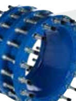
Серия 265/50 Соединитель демонтируемый для труб из всех материалов. С промежуточным фланцем. Сталь. DN 50-2200 PN10, PN16 или PN 25
