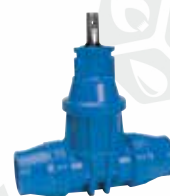
Серия 16/50 Ответвительная задвижка С муфтовыми соединениями устойчивыми к растяжению для труб ПЭ DN 25-50 PN 16 Полиоксиметилен
