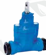
Серия 03/90 Ответвительная задвижка С соединителями "PRK" на концах для труб ПЭ DN 20-50 PN 16 Ковкий чугун
