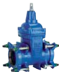
Серия 01/70 Клиновая задвижка с соединительной муфтой Supa Plus™ для труб из НПВХ и ПЭ DN 40-300 PN 16 Ковкий чугун
