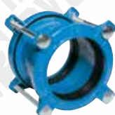
Серия 601 Прямой соединитель Supa® универсальный для труб из НПВХ, АЦ, стали, литейного и ковкого чугуна. Ковкий чугун DN 40-400 PN 16
