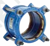
Серия 621/10 Прямой соединитель Supa Plus™ Упругий (устойчивый) для ПЭ и НПВХ труб. Ковкий чугун DN 32-300 PN 16
