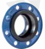
Серия 05 Обжимной чугунный фланец COMBI Не устойчивый к растяжению Для труб из ПВХ DN 50-300 PN 10/16
