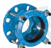
Серия 603 Фланцевый адаптер Supa® универсальный для труб из НПВХ, АЦ, стали, литейного и ковкого чугуна. Универсальная рассверловка Ковкий чугун DN 40-400 PN 10/16
