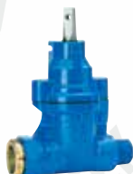
Series 03/85 Ответвительная задвижка С обжимным фиксирующим соединителем для труб ПЭ/с наружной резьбой DN25-32 PN16 Ковкий чугун
