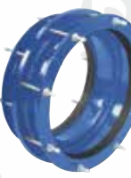
Серия 259 Редукционный соединитель Для стальных, чугунных и АЦ труб. корпус из стали DN 350-2000 PN 8 до 25
