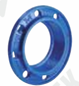
Серия 05 Фланец COMBI неупругий для труб из НПВХ, стали или ковкого чугуна. Материал – ковкий чугун. DN 400-600 для труб из НПВХ или ковкого чугуна. DN 50-300 для стальных труб PN 10/16
